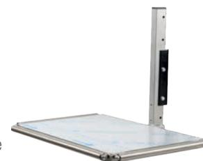
Plate-forme avec trois rouleaux d'aide au chargement. À la hauteur de levage la plus basse, le bord supérieur de la plate-forme est à environ 150 mm du sol. En combinaison avec lift2move sélectif, la charge utile maximale est de 100 kg de charge répartie.
